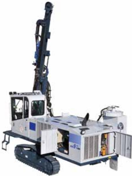
La perforadora incorpora el **Sistema de Percusión Reversa** (opcional) que mejora sustancialmente la velocidad de perforación y permite recuperar los aceros. Además cuenta con DDS sistema de doble amortiguación, una primicia de FRD en la industria. Esto minimiza el retorno de las ondas de choque, manteniendo firme la broca durante la perforación.
